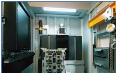
Scansione TC della testa di un cilindro
